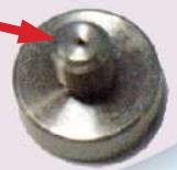
貫通穴は、ステン材は \phi 0.2 \sim 、 アルミ材・真鍮材は \phi 0.15 \sim 可能です。
